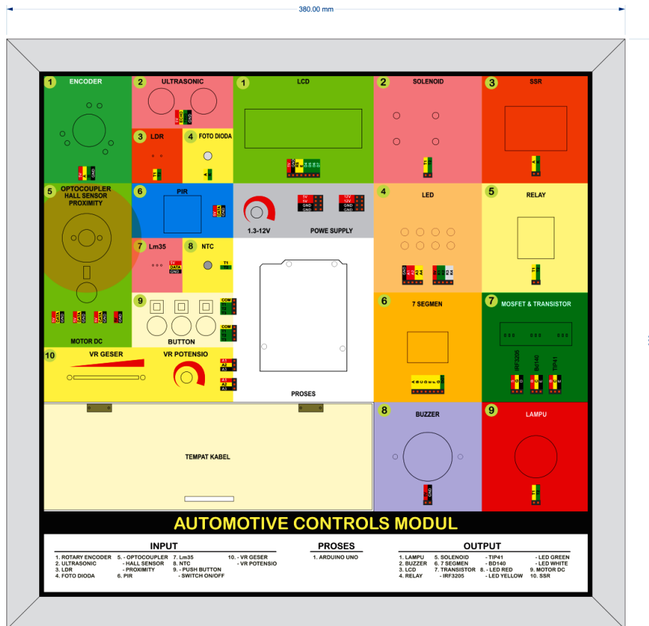
Gambar 4. Hasil revisi desain training kit dasar sistem kontrol elektronik otomotif
